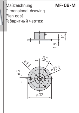
MF-06-M Montageflansch aus Metall Mounting flange, metal Bride de montage en métal Присоединительный фланец из металла
