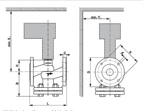
X/Y: Mindestabstand bezogen auf die Ventilmitte. Die Abmessungen des Antriebes sind dem jeweiligen Antriebsdatenblatt zu entnehmen.
