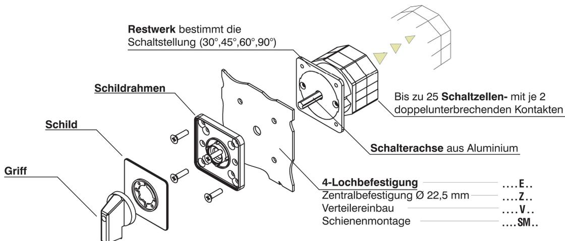
1) Steuerschalter mit Doppelkontakten und erhöhter Kontaktsicherheit.
