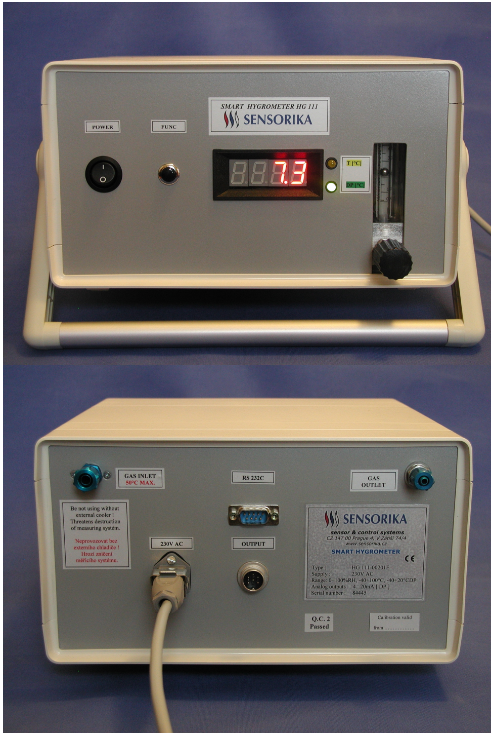
Pohled na čelní a zadní stranu hygrometru HG 111-00201F Zákaznické provedení hygrometru s nasávací vývěvou (membránovým čerpadlem) a plováчковým průtokoměrem 0 ÷ 4 litrů/min
