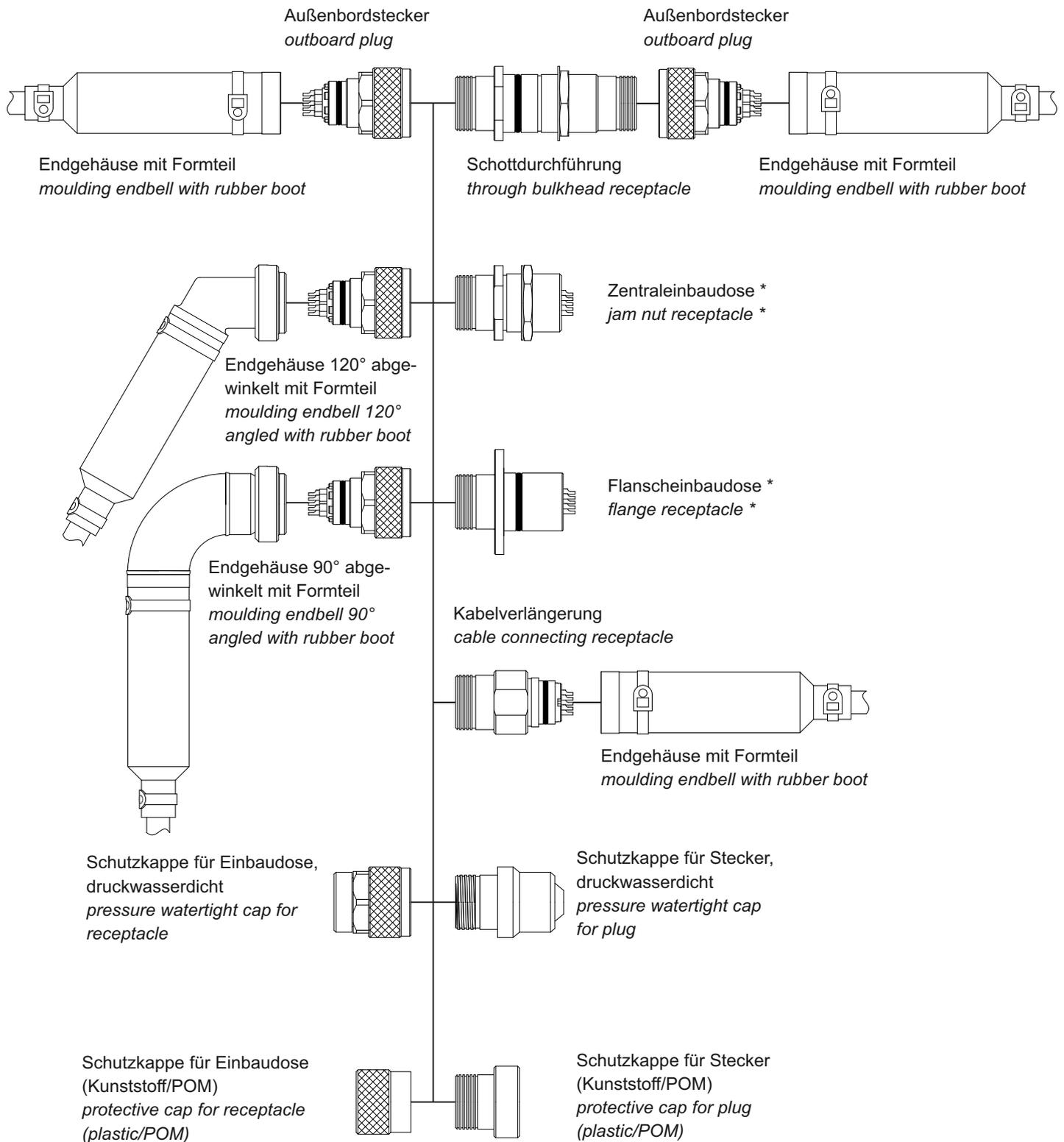
\* Sonder-Einbaudose mit Spacer-Gewinde auf Anfrage erhältlich
