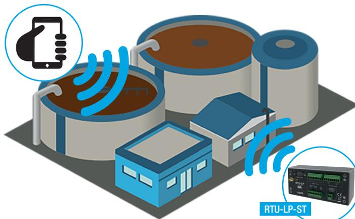
Telecontrollo impianto di depurazione con apparato GSM/GPRS a batteria e basso consumo
